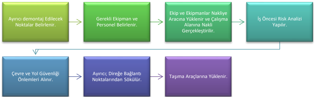
Şekil 4.10 Ayırıcı demontaj işi akışı
