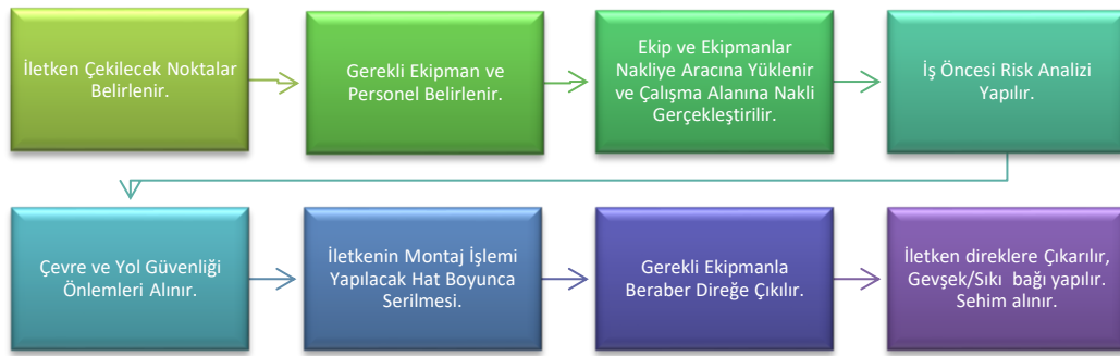
Şekil 4.7 İletken montaj iş akışı
