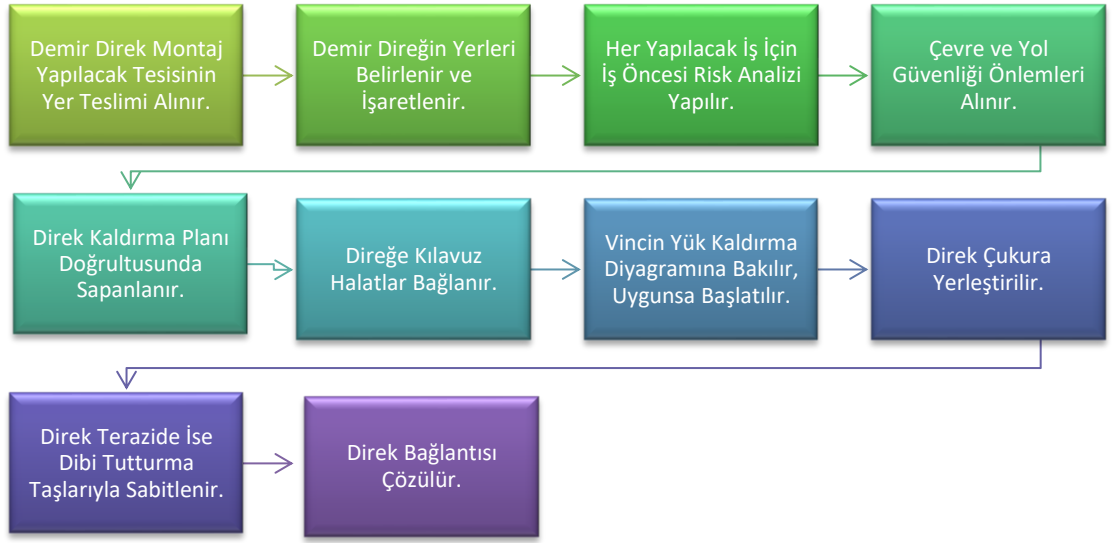
Şekil 4.4 Demir direk montaj iş akışı
