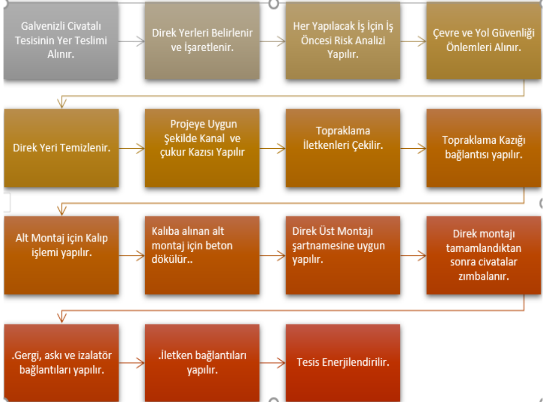
Şekil 4.24 Galvaniz civatalı demir direk tesis işleri iş akışı
