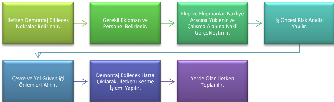
Şekil 4.8 İletken demontaj iş akışı
