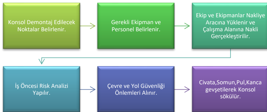
Şekil 4.14 Konsol / Travers demontajı iş akışı
