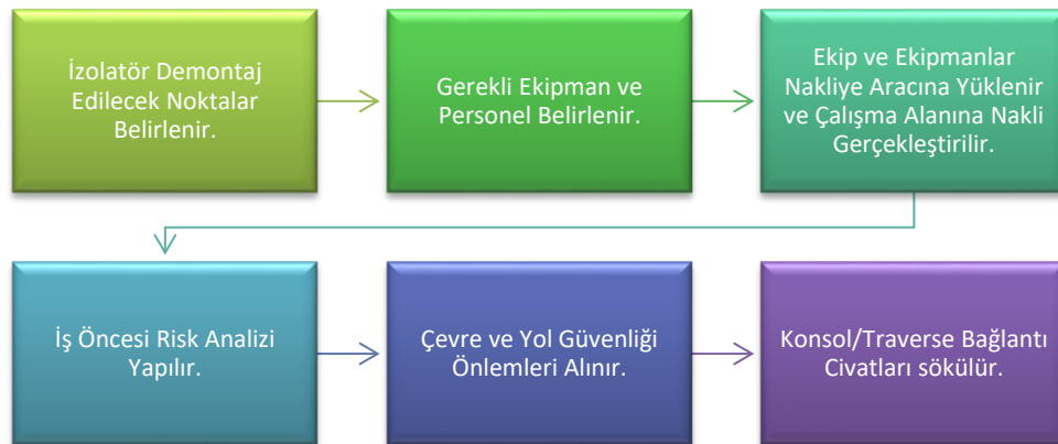
Şekil 4.12 İzolatör demontaj işi akışı
