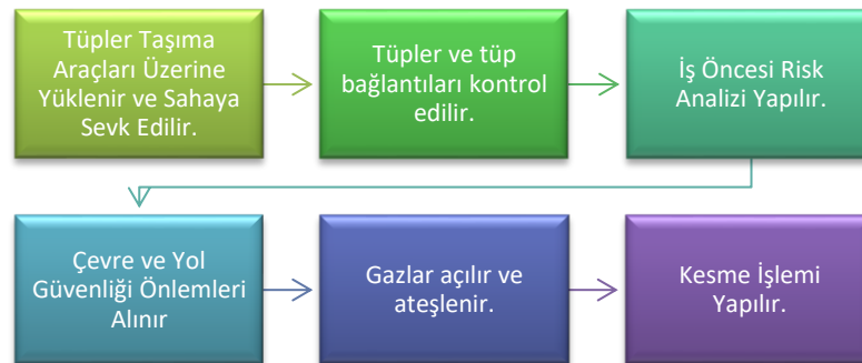
Şekil 4.16 Oksi-LPG direk ve saç köşk demontaj iş akışı
