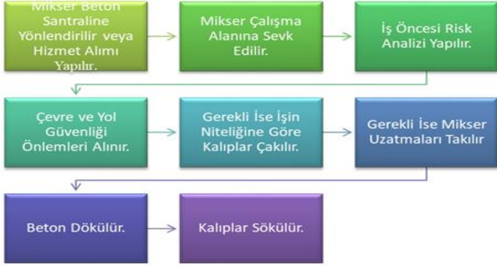
Şekil 4.1 Beton atma iş akışı
