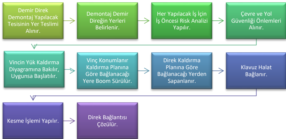
Şekil 4.5 Demir direk demontaj iş akışı
