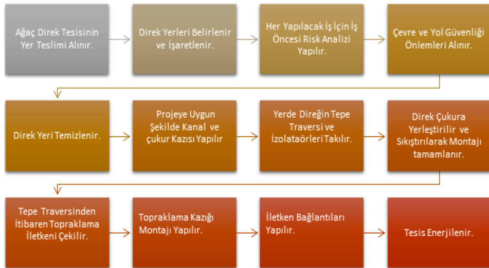
Şekil 4.23 Yüksek gerilim ağaç direk tesis işleri iş akışı
