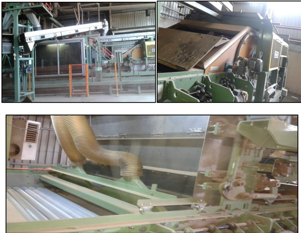
Fotoğraf 2.12. Serme makinası (a. Serme makinası genel görünüşü, b. ÜT serme makinası, c. OT serme makinası merdaneleri)
