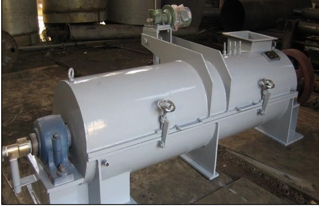
Fotoğraf 1.8. Enjektörlü tip tutkallama makinası görünümü(URL-15, 2015).
