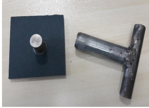
Fotoğraf 4.7. Çelik silindirin deneş örneğine yapıştırılması
