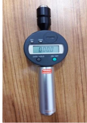
Fotoęraf 4.6. Shoremetre-D sertlik lme cihazı
