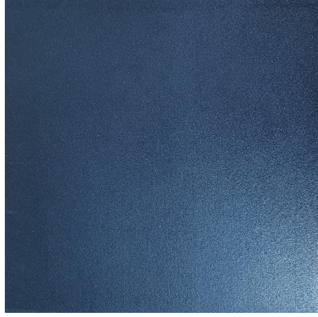
Fotoğraf 4.4. Laminat ve masif parke astarlarına uygulanan su bazlı ısı yalıtım boyasının portakal yüzey görünümündeki kurumuş hali
