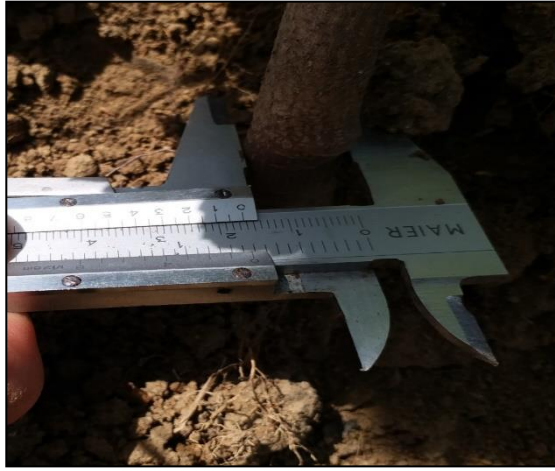
Şekil 3.2. Fidanların Kök Boğaz Ölçümünde Kullanılan Milimetrik Kumpas
