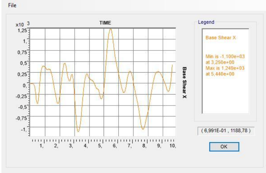
Şekil 5.96 İzolatörlü yapının taban kesme kuvvetleri
