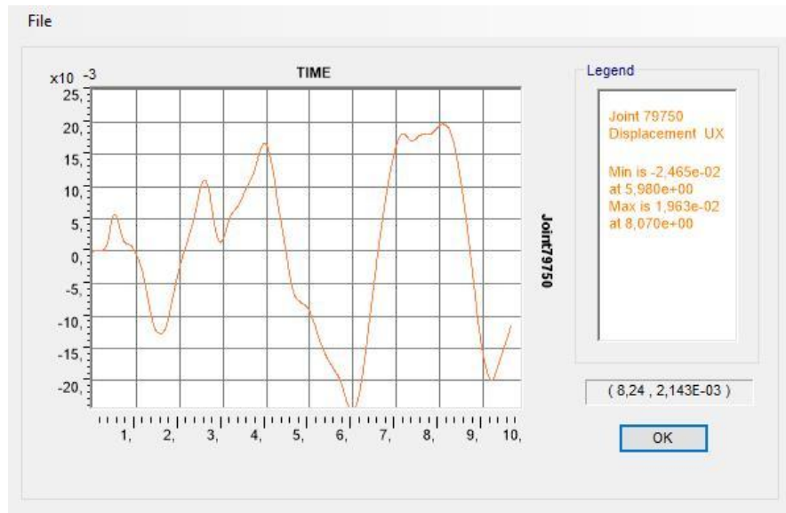
Şekil 5.95 İzolatörlü yapının tepe noktası deplasmanları
