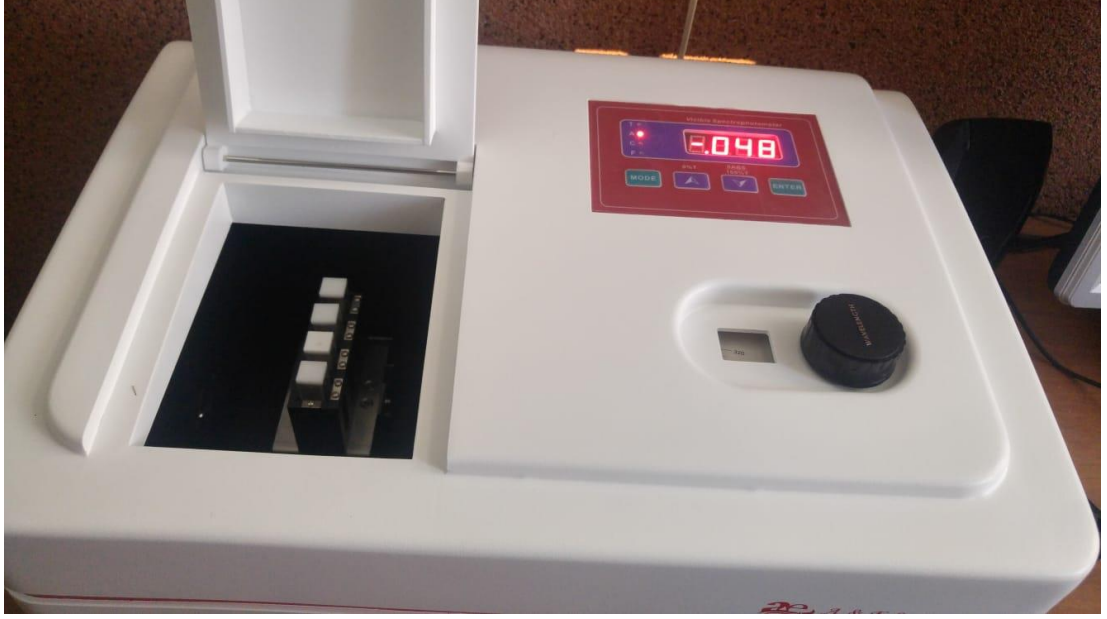
Fotoğraf 3.11. Spektrofotometre kuarzt tüp yerleştirme kısmı
