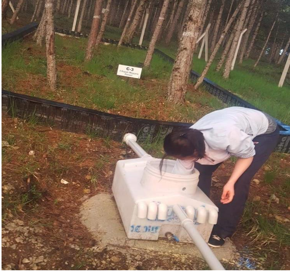
Şekil 3.5 Yüzeysel akış miktarının ölçülmesi
