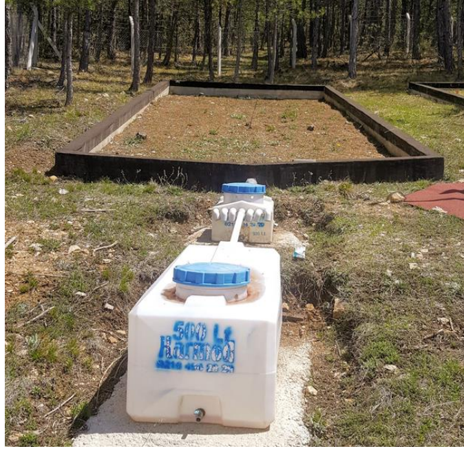
Şekil 3.4 Çalışma kapsamında kurulan yüzeysel akış düzeneği
