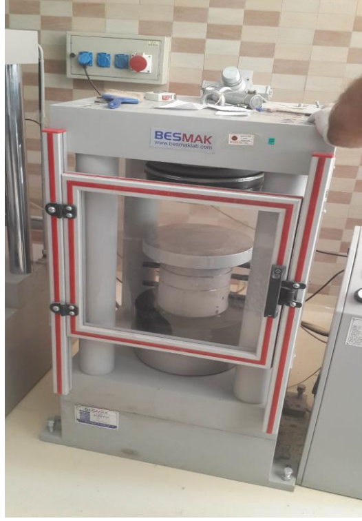
Şekil 3.13. Basınç dayanımı deneyi
