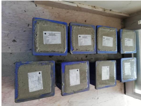
Şekil 3.10. Numunelerin kalıplara yerleştirilmesi
