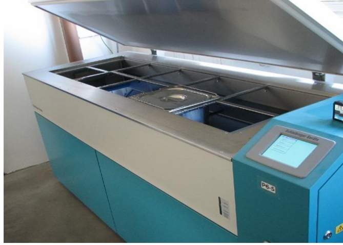
Şekil 3.12. Donma-çözünme deney cihazı
