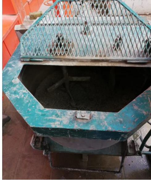
Şekil 3.9. Hafif beton malzemelerinin karıştırılması
