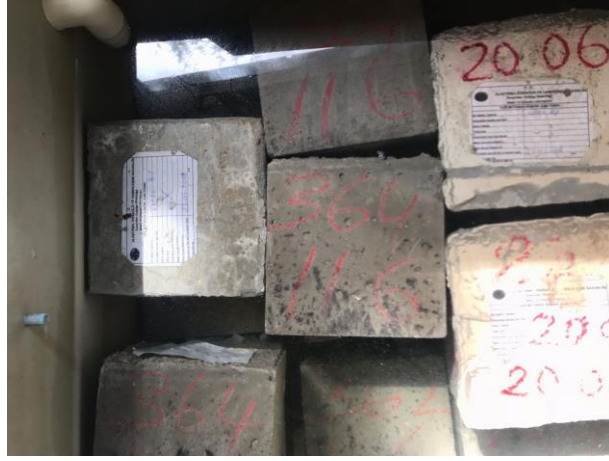
Şekil 3.11. Numunelerin kür edilmesi
