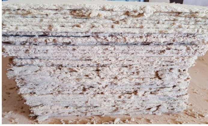
Şekil 4.10. Üretimi yapılan LİFLEVHA deney levhaları (Foto: Başarrı, G.).
