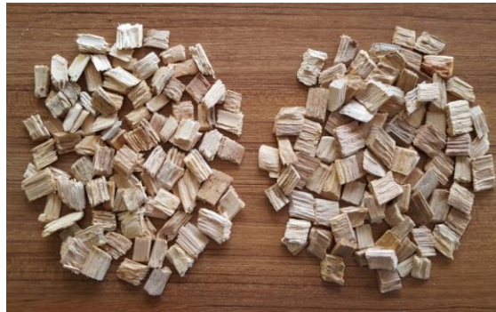
Şekil 4.7. Kızılçam (sağ) ve Doğu kayını (sol) yonga örnekleri (Foto: Başarır, 2015).
