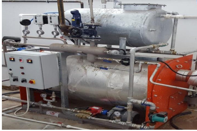
Şekil 4.1. Laboratuvar tipi buhar jeneratörü (Foto: Başarır, 2015)
