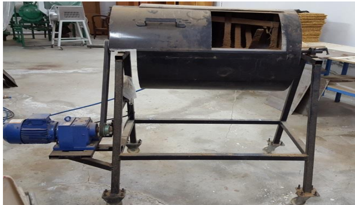
Şekil 4.4. Laboratuvar tipi tutkallama mikseri (Foto: Başarır, 2015)
