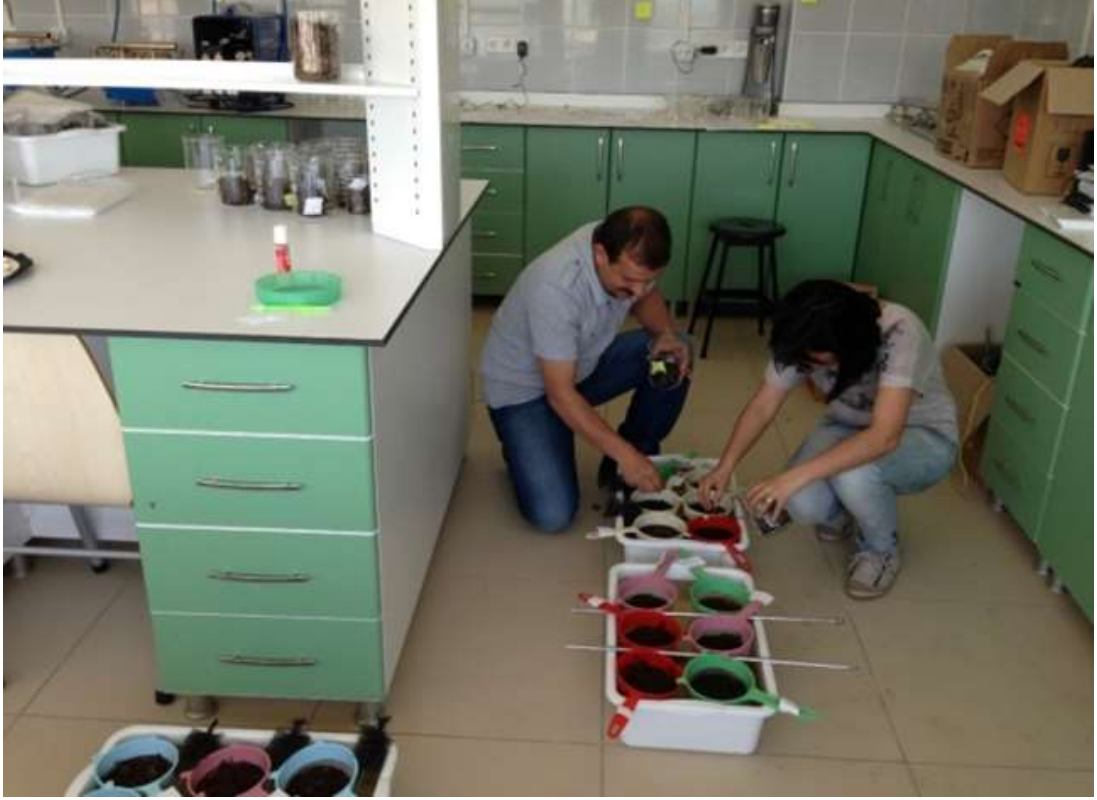
Fotoğraf 3. 12. Ölü örtü örneklerinin su tuma kapasitesi ölçümü
