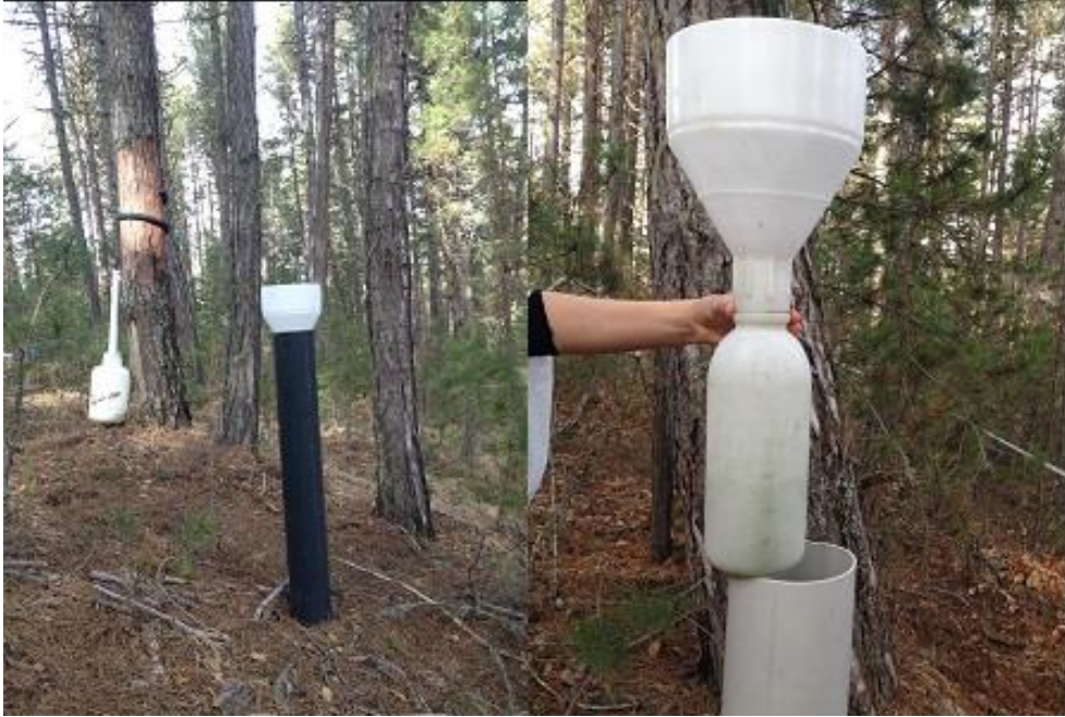
Fotoğraf 3.5. Orman altı yağışı ölçmek için deneme alanı içine kurulan standart yağış ölçerler
