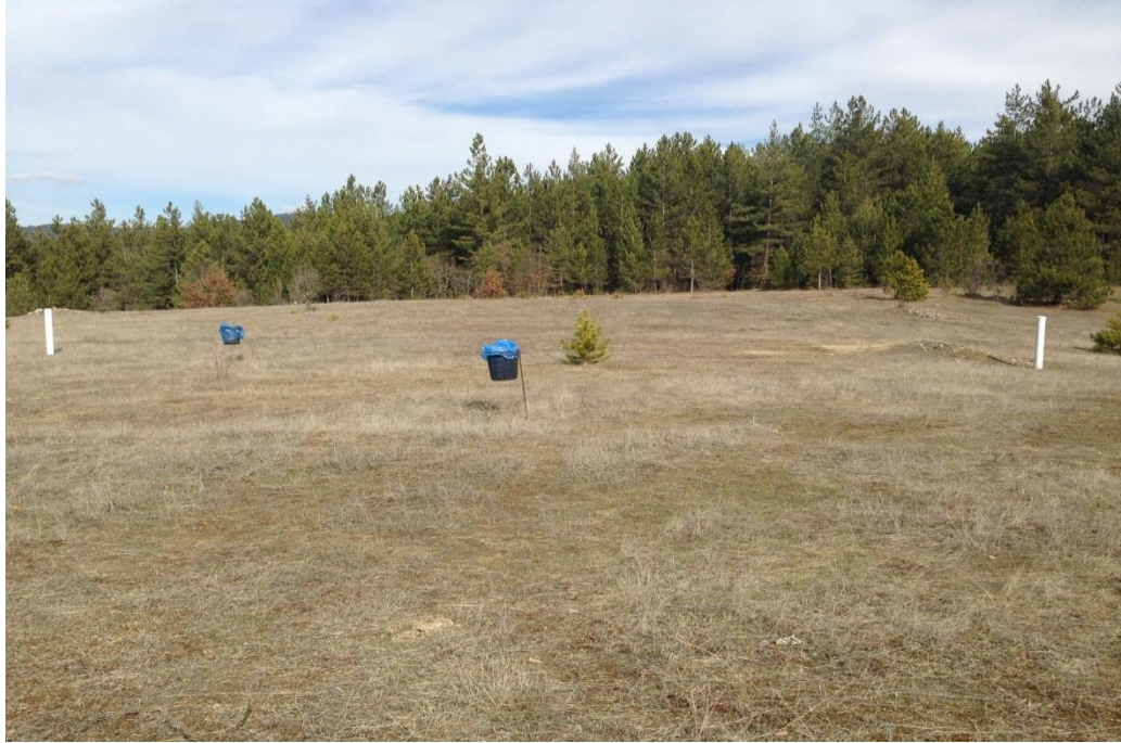
Fotoğraf 3.4. Deneme alanlarına yakın mesafede seçilen açık alana dört adet standart yağış ölçer kurulmuştur
