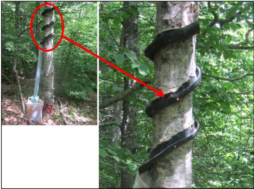
Fotoğraf 3.6. Gövdeden akışı ölçmek için kurulan gövdeden akış düzeneği
