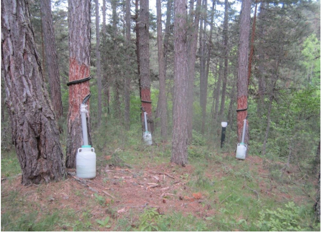
Fotoğraf 3.7. Ağaç gövdesine kurulan gövdeden akış düzeni
