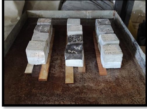
Şekil 3.13 Hazırlanan numunelere uygulanan su emme testi
