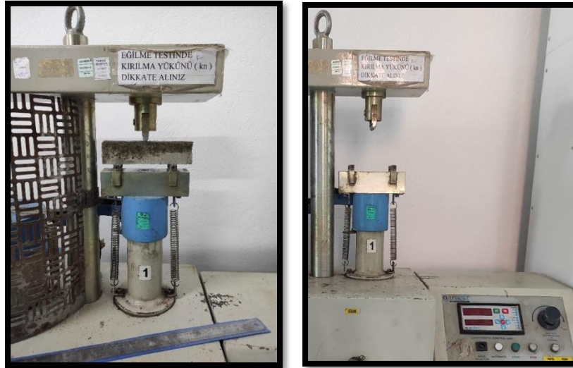
Şekil 3.15 Eğilme test cihazı ve hazırlanan numunenin teste tabi tutulması
