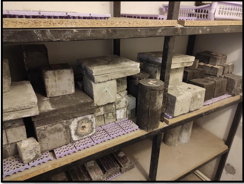
Şekil 3.10 Kür odasına alınan geopolimer numune örnekleri
