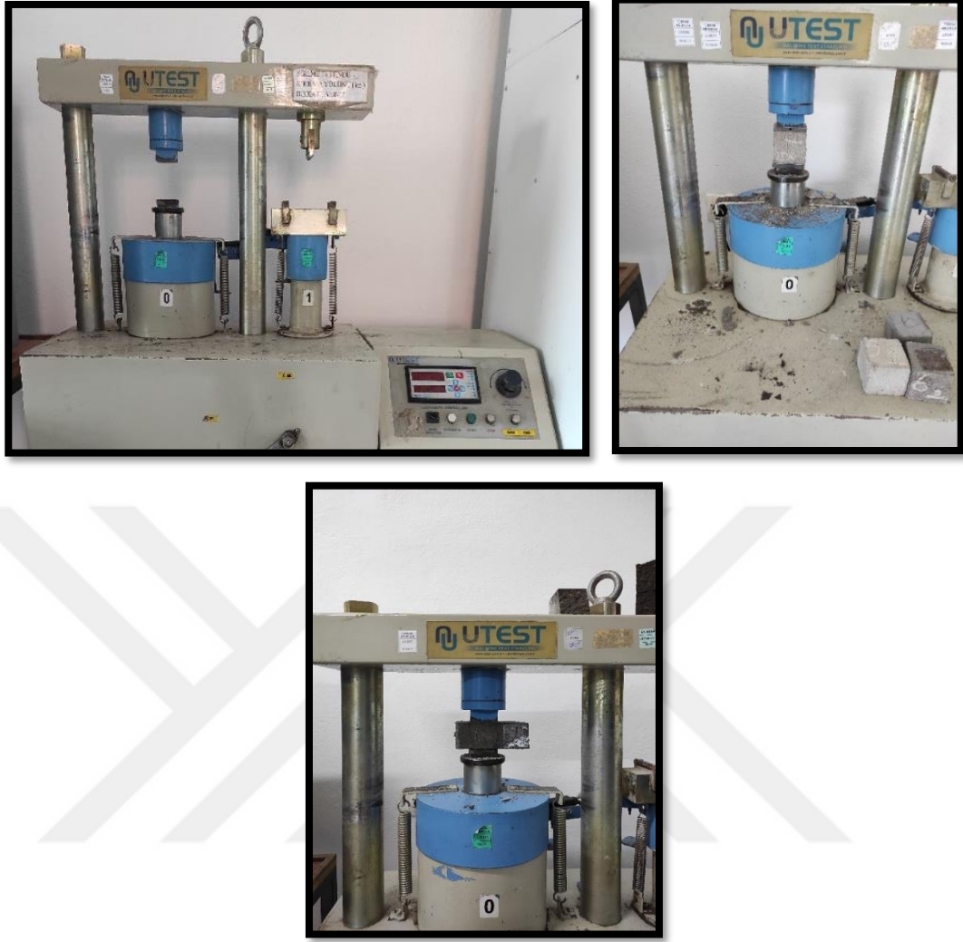
Şekil 3.14 Hazırlanan geopolimer beton numunelerinin basınç testi
