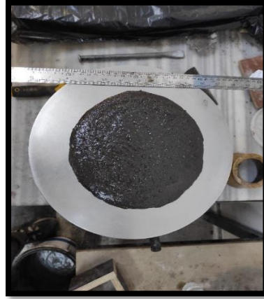
Şekil 3.8 Yayılma tablası testine tabi tutulan geopolimer numune
