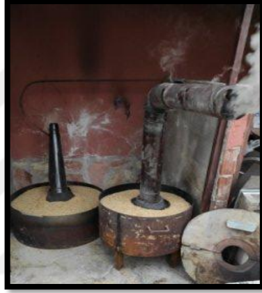
Şekil 3.1 Pirinç kabuğunun yakılması
