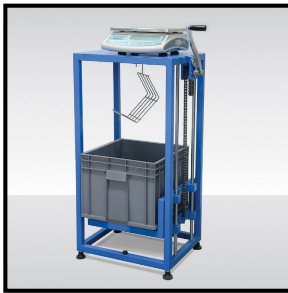
Şekil 3.12 U-Test Arşimet deney düzeneđi
