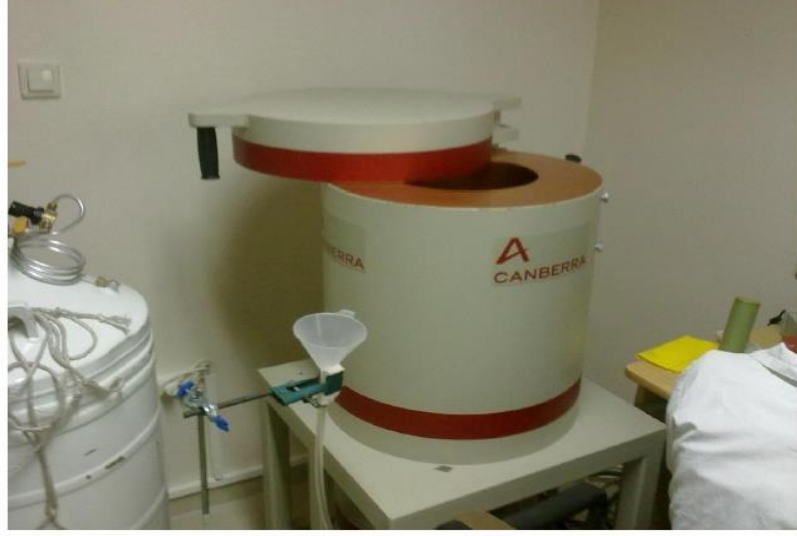
Şekil 2.1. Saf germanyum detektörlü gama spektrometrik ölçüm sistemi
