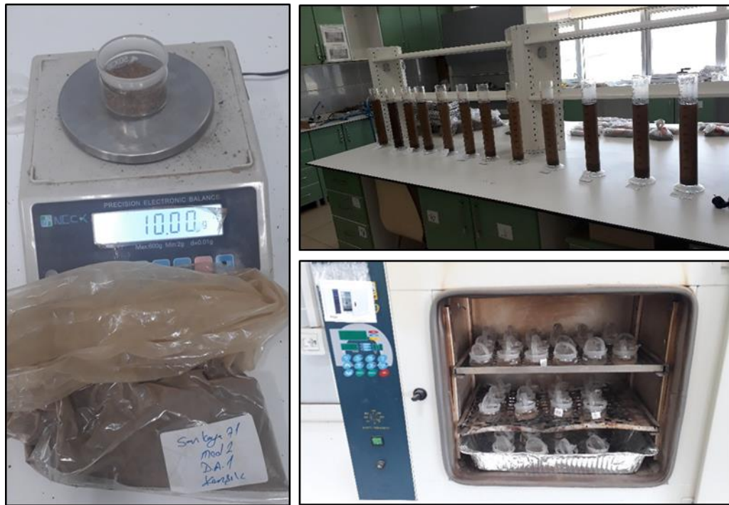
Şekil 3.13 Toprak tekstürünün belirlenmesi
