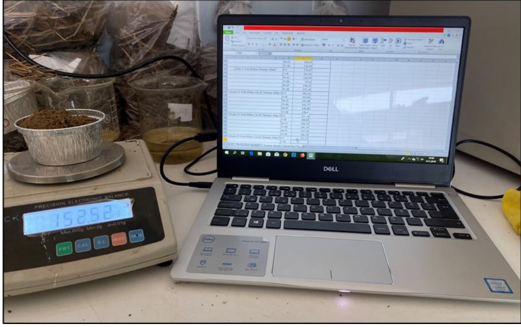
Şekil 3.9 Toprak örneklerinin yaş ve kuru ağırlıklarının belirlenmesi
