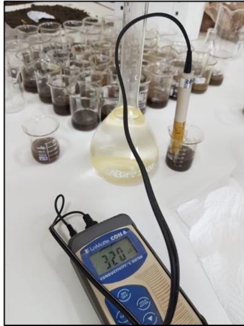
Şekil 3.12 Toprak örneklerinden elde edilen çözeltilerde elektriksel iletkenlik ölçümü
