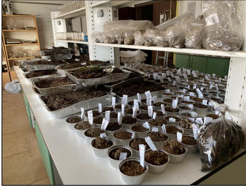
Şekil 3.7 Toprak örneklerinin laboratuvarında hava kurusu hale getirilmesi
