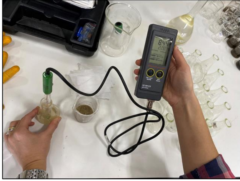
Şekil 3.11 Toprak örneklerinden elde edilen çözeltilerde pH ölçümü
