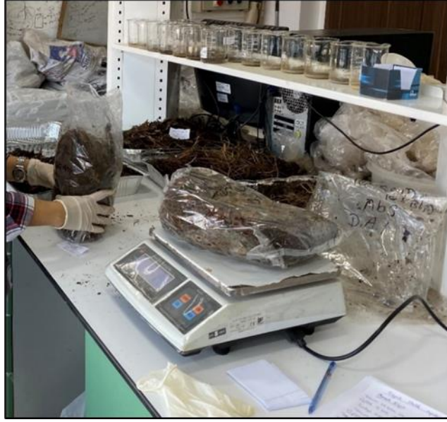
Şekil 3.14 Ölü örtü örneklerinin yaş ağırlıklarının tespiti
