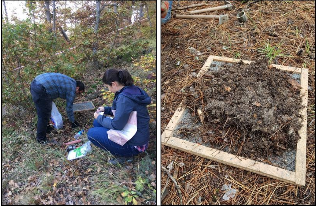
Şekil 3.5 Toprak yüzeyi ölü örtü örneklerinin alınması
