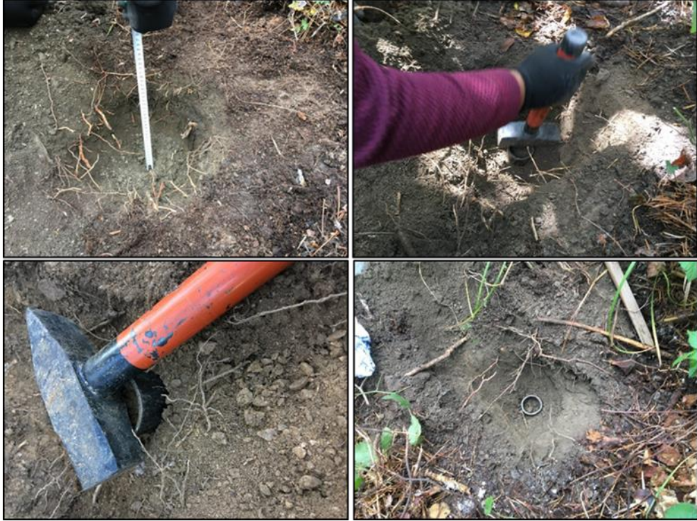
Şekil 3.6 Toprak silindiri yardımıyla toprak örneklerinin alınması
