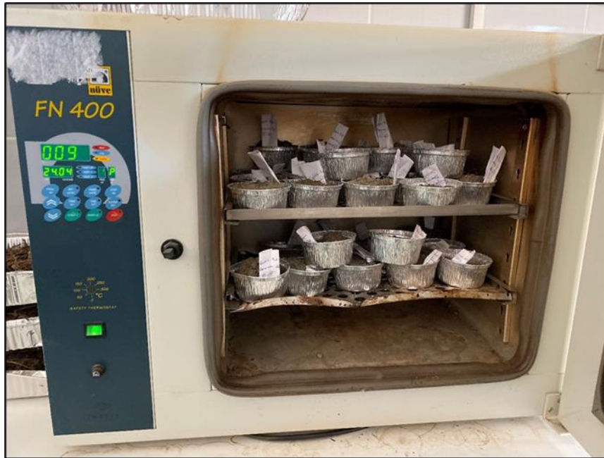
Şekil 3.8 Toprak örneklerinin etüv yardımıyla kurutulması
