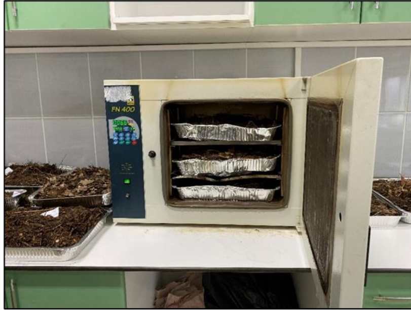
Şekil 3.15 Ölü örtü örneklerinin etüv yardımıyla kurutulması
