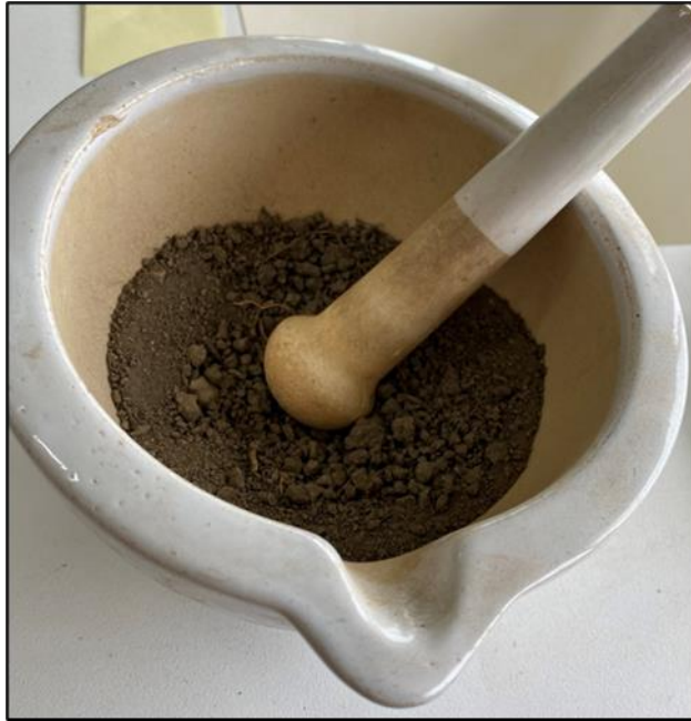
Şekil 3.10 Toprak örneklerinin porselen havanlarda öğütülmesi
