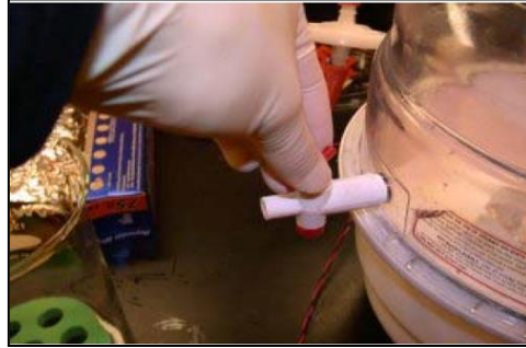
Şekil 3.8 Gazdan arındırma işleminde kullanılan vakumlu desikatör
